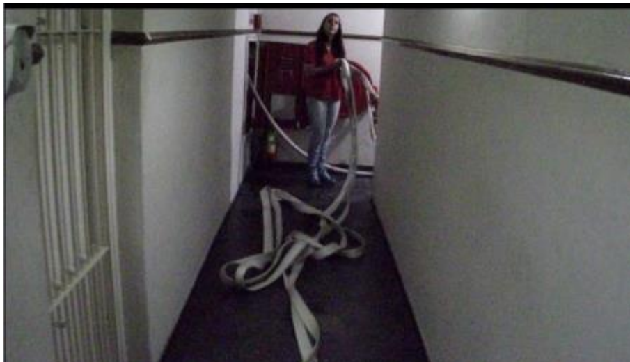
Foto 11 – Não foi possível a montagem da linha da mangueira de 30m
