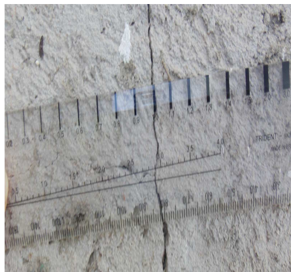
Figura 40: Fissura com 1mm de abertura, sendo: (a) aspecto geral da alvenaria com fissuras e (b) detalhe de medição da abertura da fissura em campo.
